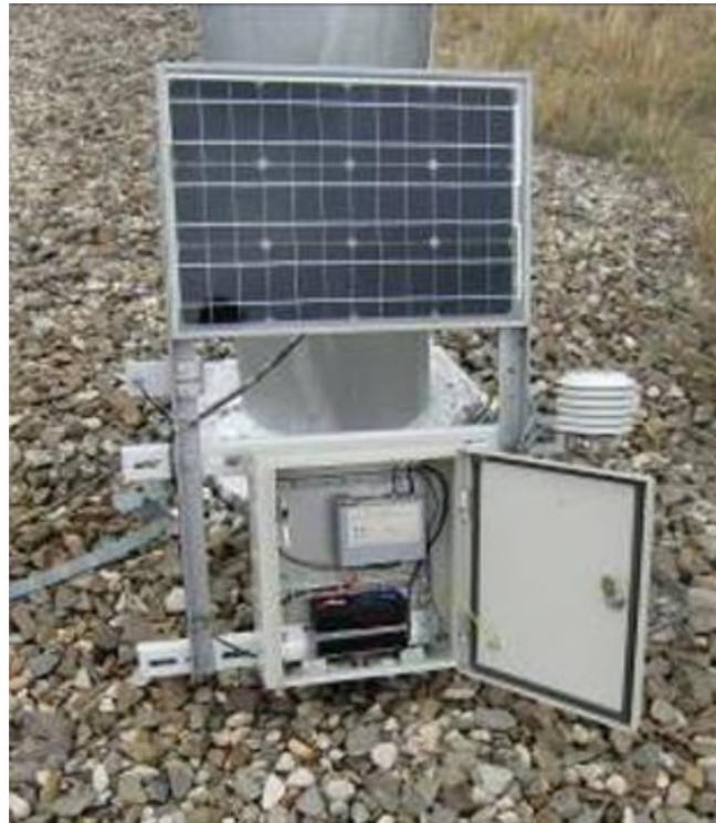
Рисунок 4.4 – Устройство приема-передачи информации на диспетчерский пункт
